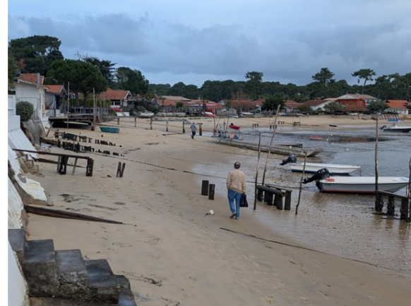
Figure 1-20 Exemple d'abaissement du niveau de plage à différents endroits du Canon nécessitant l'utilisation de structures sur pieux.
